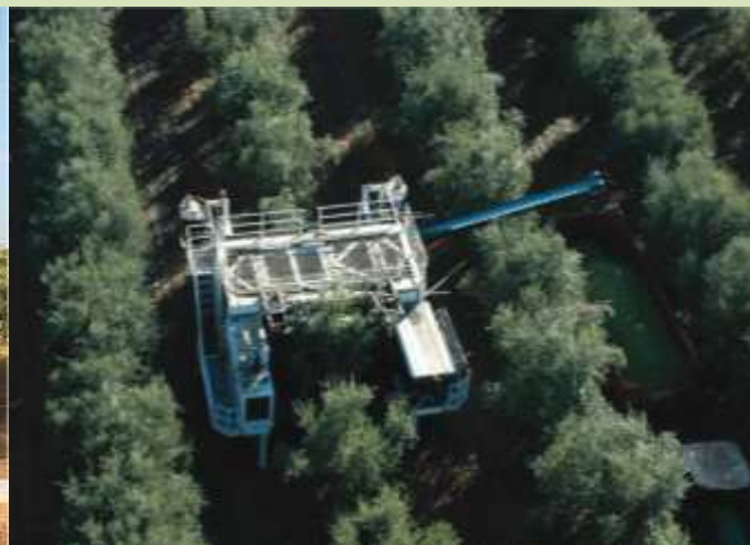
شکل ۱۰- برداشت با برداشت‌کننده‌های پیشرفته روی درختان بالغ زیتون.
