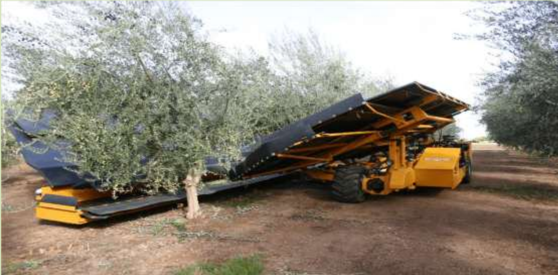
شکل ۹- لرزاننده تنه دو طرفه (Side-by-side) که روی یک درخت ۵ ساله کار می‌کند.
