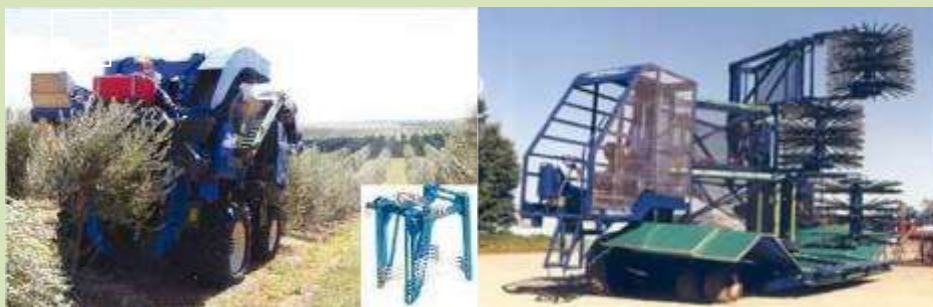
شکل ۸- برداشت کننده با شانه جانبی (الف، شکل سمت راست)، و برداشت کننده استرادل (ب، شکل سمت چپ).
